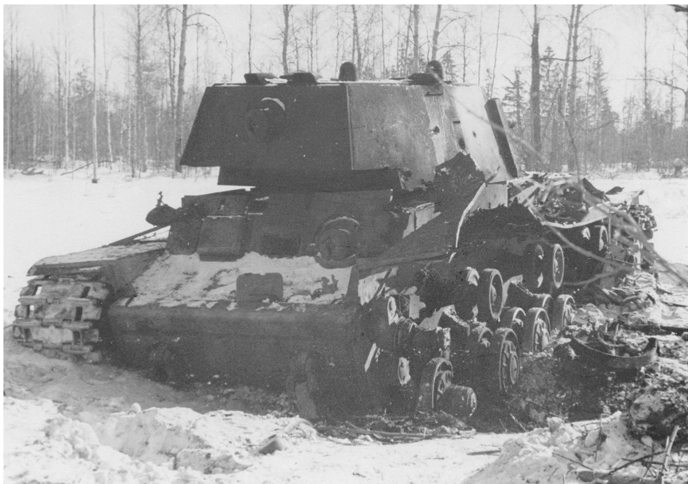
Tung sovjetisk KV-1 kampvogn ødelagt i 1942 af en træffer af en middeltung artillerigranat i venstre side. Sidepansret er ødelagt, så besætningen er næppe sluppet. Det var den konstante risiko for de danske vogne og besætninger. (Foto: reddit.com)
